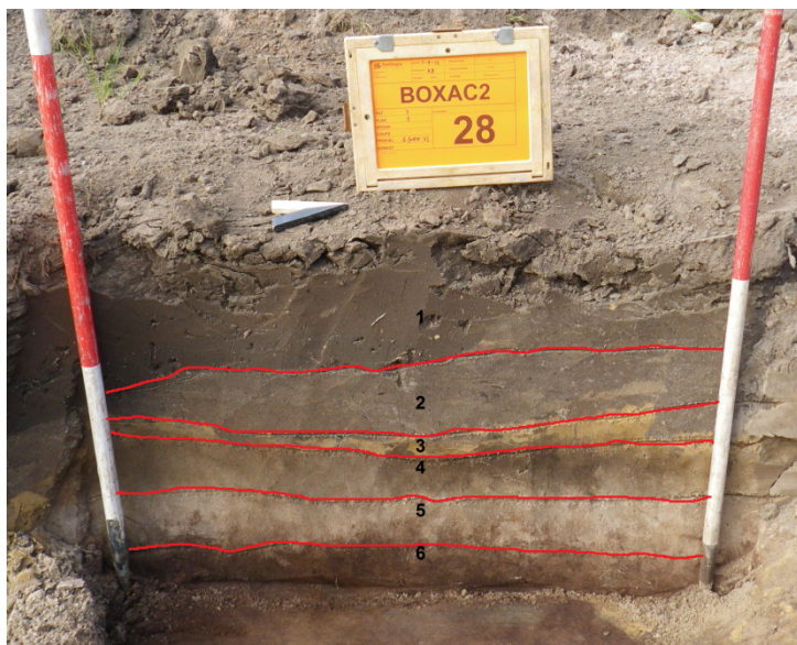
Afbeelding 3.7: profiel 3.6. Van boven naar beneden: (1) bouwvoor; (2) opgebrachte laag; (3) opgebrachte laag; (4) oude bouwvoor; (5) E/B-horizont; (6) B-horizont.
